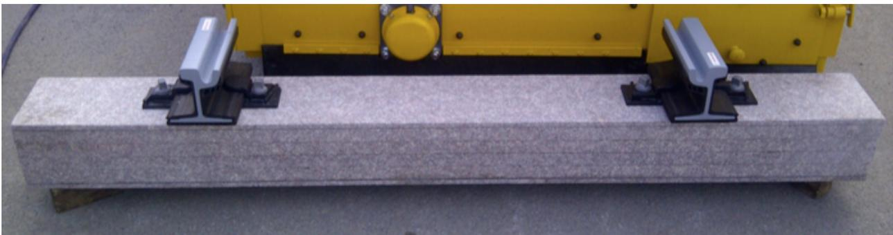
Bahnschwelle aus 6 Schichten Granit für einen Lastfall von 176kN am Schienen-Auflager
