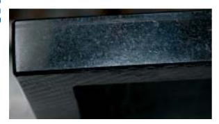
Hier wird nichts versteckt: die dünne CFK-Armierung ist zwischen Platte und Sichtrahmen zu erkennen. Von diesen Produkten ist der Weg zum Einsatz von CFS im Rotor für Windkraftwerke oder für Flugzeugflügel nicht mehr weit, denn auch hier kommt es auf Hochfestigkeit und Elastizität, geringes Gewicht und hohe Vibrationsdämpfung sowie auf eine extreme Ermüdungsfestigkeit an – Eigenschaften, die der CFS hervorragend erfüllt.
