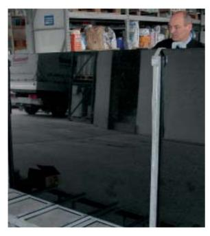
Die Spiegelung beweist: die wenige Millimeter dünnen CFS-Platten sind völlig verzugfrei.
