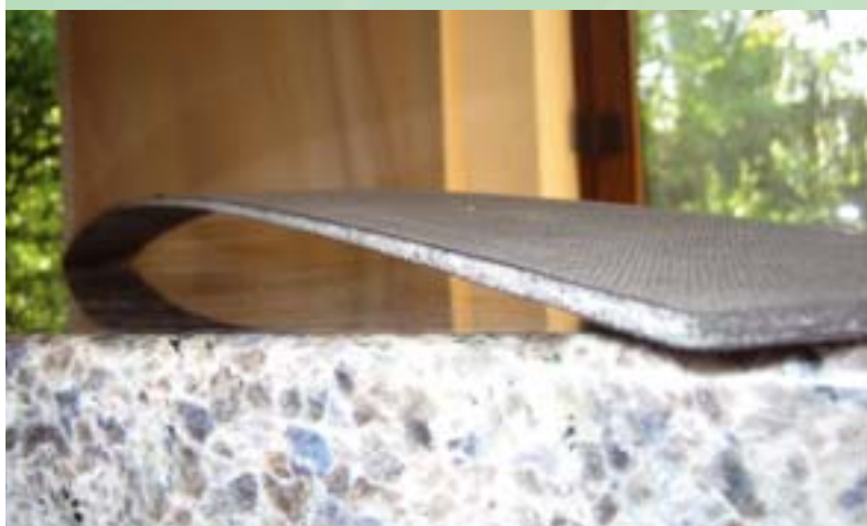
Selbstgedämpfte Blattfeder aus 4 mm dünnem Calanca-Gneis mit 0,5 mm dünnen Carbonfaserschichten an Ober- und Unterseite
