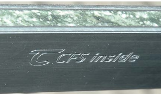
CFS inside: Der Verbundwerkstoff bildet den Kern des Skis. Erhältlich ist er auf der Basis von Andeer (oben) und Calanca Gneis (rechts).
