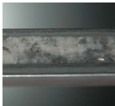
CFS inside: Der Verbundwerkstoff bildet den Kern des Skis. Erhältlich ist er auf der Basis von Andeer (oben) und Calanca Gneis (rechts).
