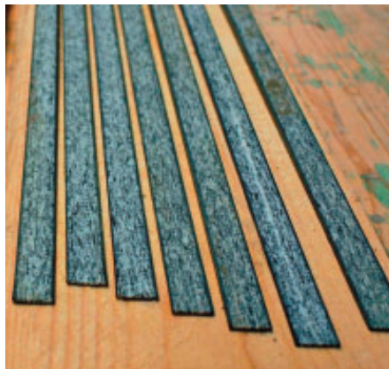
Streifen aus Stein: Das Rohmaterial für die Skierstellung kommt aus einem Gneis-Steinbruch. Es wird entsprechend zugeschnitten.
