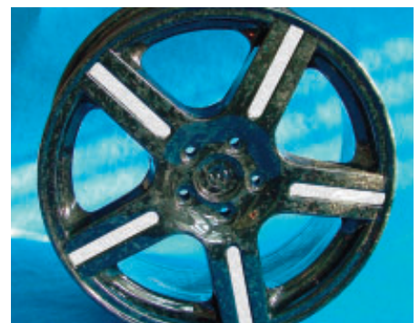
Auf dem Weg in den Markt: Die Zuverlässigkeit leichter Kunststoff-Felgen wird per Simulation getestet. Foto: LBF
